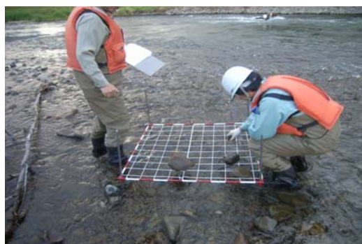
図1 面積格子法による試料採取
