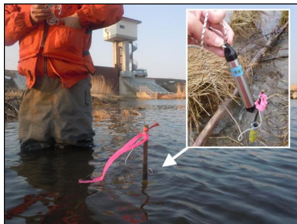
写真1 簡易水位計設置状況
