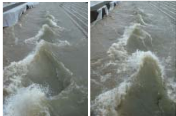
図-2 (左) 発生後3分における発達した水面波列(流量約 30\text{m}^3/\text{s} )
