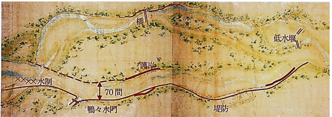
図3 札幌市街地水害防禦工事計画
